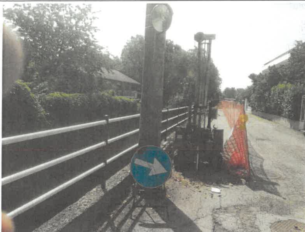
Foto 3-4 Area in esame con attrezzatura utilizzata per l'esecuzione delle prove penetrometriche e stendimento sismico di tipo MASW
